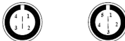
Bild 5: Pinout anslutning externt: 4 pin (vän) och 5 pin (höj)
