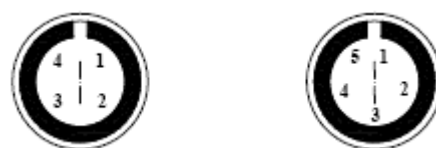
Bild 5: Pinout anslutning binder hona (sedd utifrån): 4 pin (vän) och 5 pin (höj)
